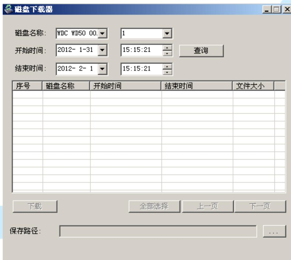
我们可以根据硬盘录像的开始时间和结束时间来查询硬盘数据并进行下载，当然只能下载硬盘坏道之前的硬盘数据；当硬盘坏道严重的，则该硬盘下载工具将无法检测到硬盘，从而无法对硬盘数据进行下载。
