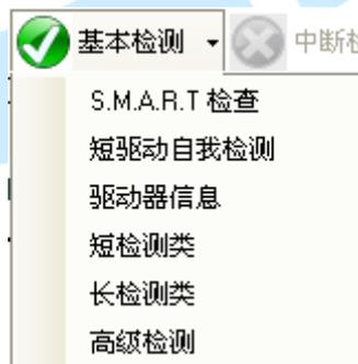
**SMART 技术：**全称“Self-Monitoring, Analysis and Reporting Technology”即“自检测、分析及报告技术”。SMART 检测的对象包括对硬盘的磁头、磁盘、马达、电路等，由硬盘的检测电路和主机上的监测软件对被监测对象的运行情况与历史记录及预设的安全值进行分析、比较，当出现安全值范围以外的情况时，会自动向用户发出警告，而更先进的技术还可以提醒用户自动降低硬盘运行速度，把重要数据文件转存到其他安全扇区，甚至把文件备份到其他硬盘或存储设备。通过 SMART 技术可以确保对硬盘潜在故障进行有效预测，提高数据的安全性。
